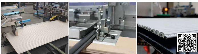
Machine pour la coupe et l'assemblage des tabliers de volets roulants en ALU
