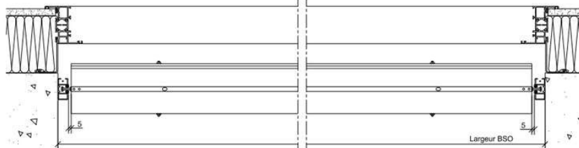
Coupe horizontale Z-Line 90 Coulisse auto-portée Lambrequin type 9
